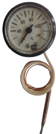
Дистанционные термометры предназначены для измерения температуры жидких и газообразных сред в промышленных условиях. Индикация изменения температуры основывается на тепловом расширении жидкости-наполнителя.
